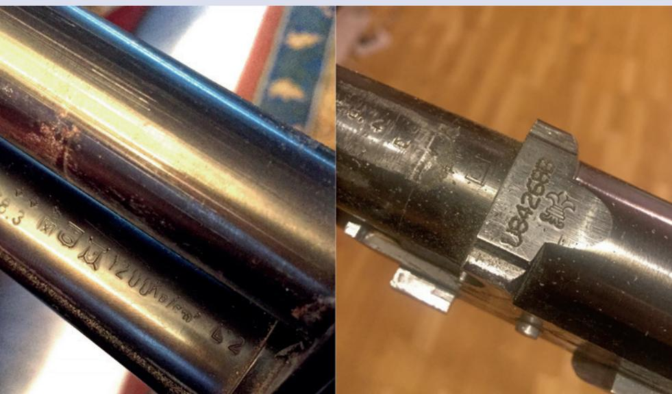
**Fig. 5.** Ejemplos de escopetas compatibles con el uso de munición de acero. A la izquierda detalle de semiautomática Benelli de más de 25 años y con grabado de haberse probado a 1.200 kg/cm<sup>2</sup>. A la derecha superpuesta Beretta de 20 años de antigüedad con la flor de lis grabada
