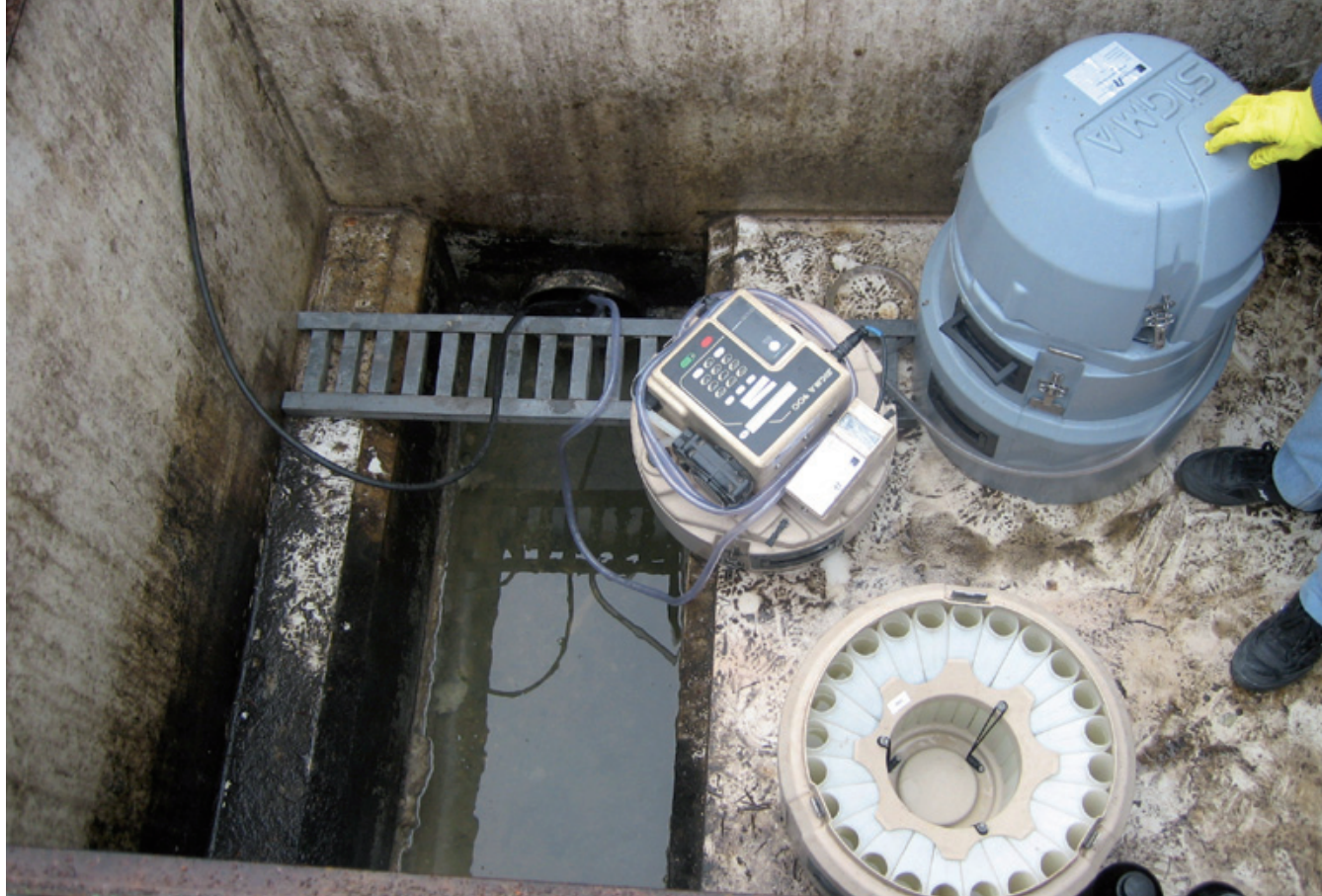
Toma de muestras en matriz líquida en actuaciones de seguimiento de actividades potencialmente contaminantes
