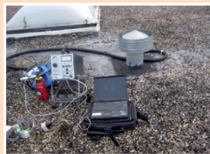
Toma de muestras de emisiones atmosféricas en focos canalizados durante los trabajos de seguimiento de las condiciones establecidas en las Autorizaciones Ambientales Integradas
