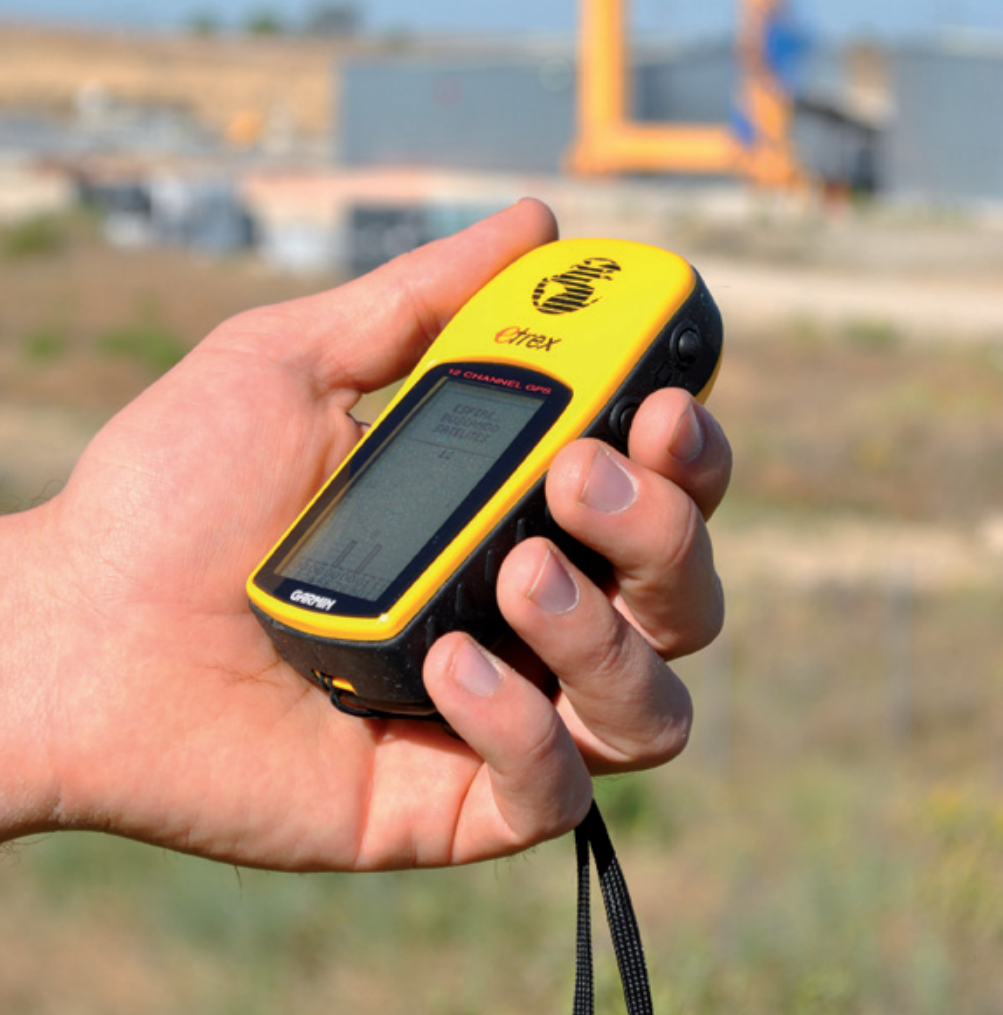
Georreferenciación mediante GPS de las actuaciones para su posterior integración en el S.I.G. de la Base de Datos de Inspección y Seguimiento Ambiental
