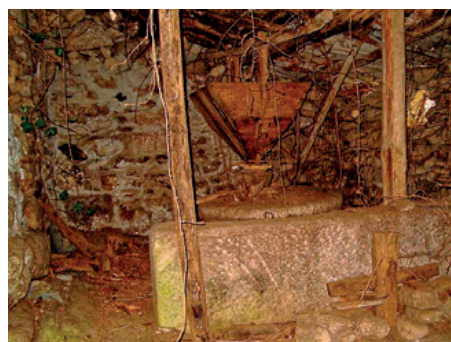
Fig. 13. Guardapolvero. Muro de piedra de aproximadamente un metro de altura que separa la entrada del molino del tremiñeiro, así como la cruceta, pieza de madera de sección cruciforme que sostiene y centra el sistema de molienda
