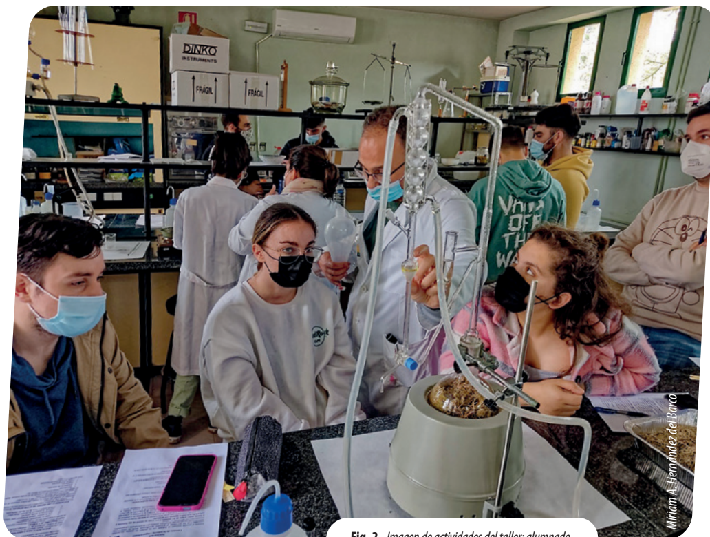
Fig. 2. Imagen de actividades del taller: alumnado investigando sobre la extracción de aceites esenciales mediante hidrodestilación
