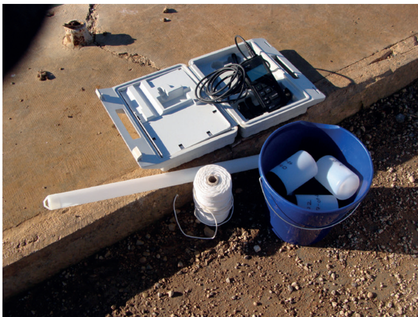
Fig. 2. Equipo para toma de muestras de agua
