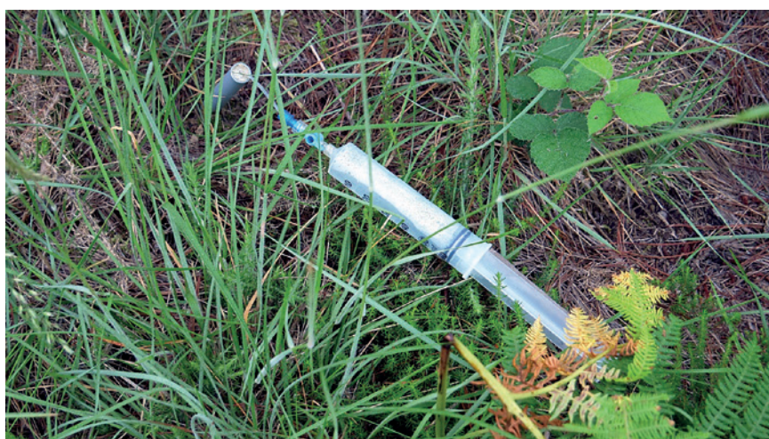
Instrumental "Rhizon" de baja presión negativa y su disposición en las parcelas
