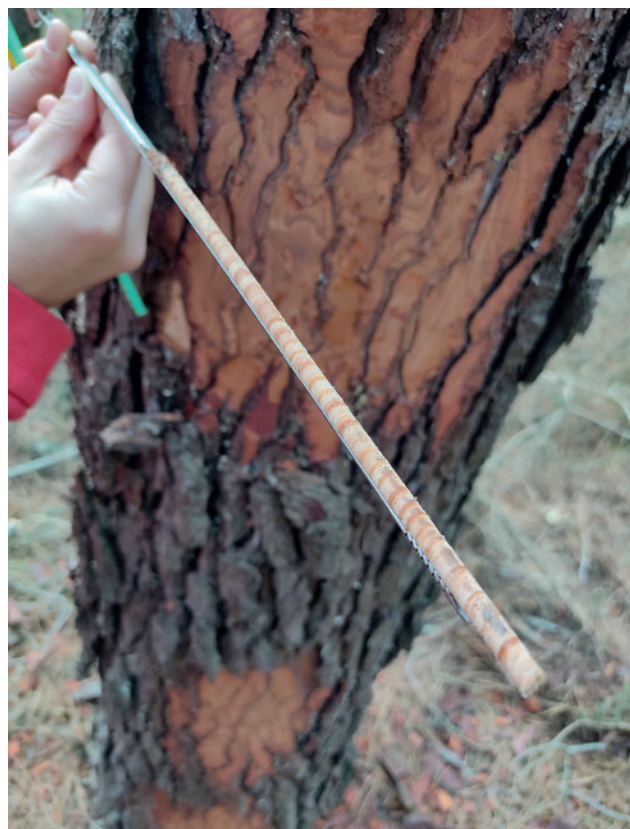
Figura 3. Extracción de testigos de madera mediante barrena de Pressler para llevar a cabo los estudios dendrométricos.
