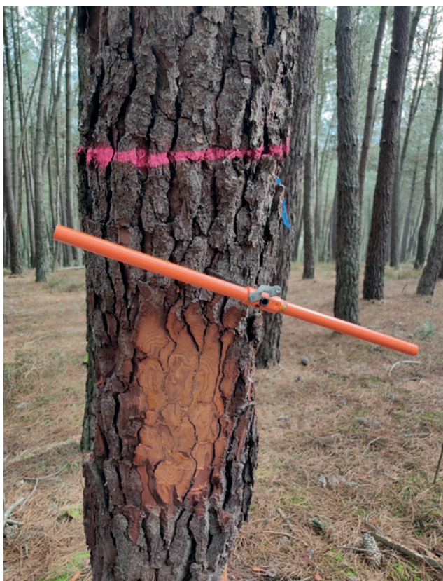
Figura 3. Extracción de testigos de madera mediante barrena de Pressler para llevar a cabo los estudios dendrométricos.
