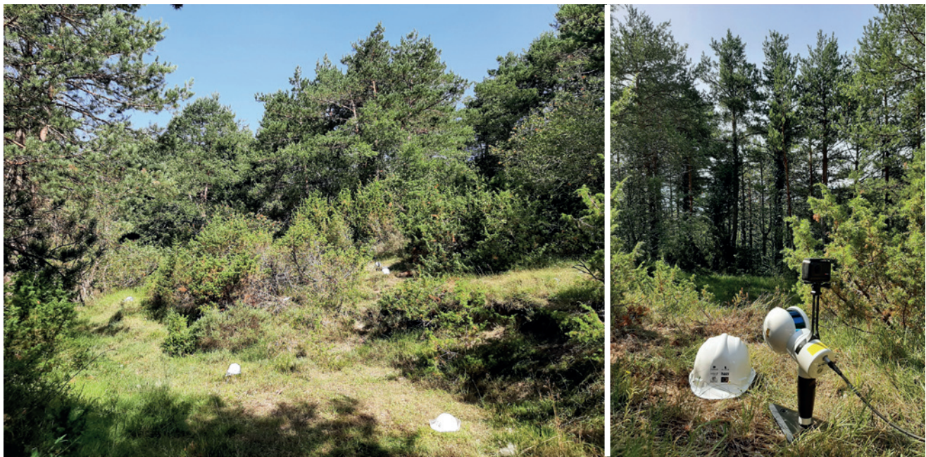
Figura 6. Ubicación de los cascos empleados para la unión de escaneos (julio 2022), y detalle de casco y láser SLAM empleado ubicados en el centro de la parcela
