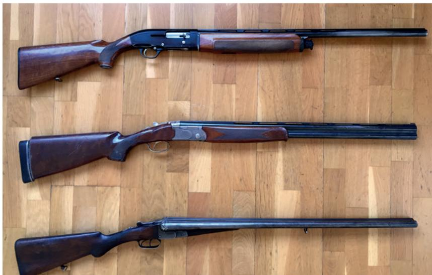
**Figura 4.** De arriba abajo, escopeta semiautomática (repetidora), escopeta superpuesta y escopeta paralela. Las dos primeras tienen una antigüedad de unos 20-25 años y son compatibles con la munición de acero. La paralela, con más de 60 años de antigüedad, no lo sería
