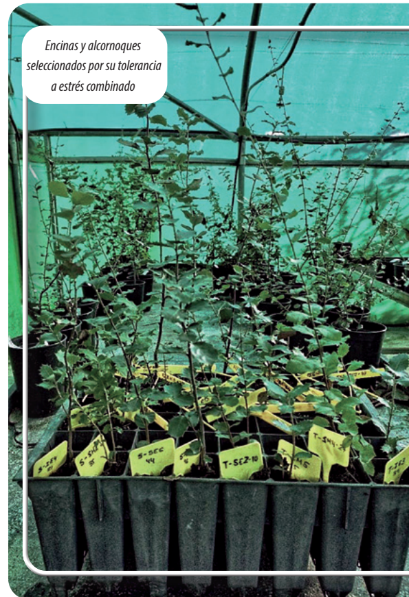
Evaluación de planta sometida durante cinco días a una ola de calor a 48 °C, en horno de metacrilato
